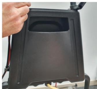
17. Remontez le réservoir de solution et le réservoir de récupération
