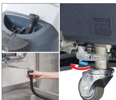
2. Remplissez le réservoir avec de l'eau propre et ajoutez un détergent adapté (dosage en fonction des spécifications). La température de l'eau ne doit pas dépasser 40 °C.
