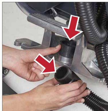
1. Vérifiez que le tuyau d'aspiration est bien installé et propre.
