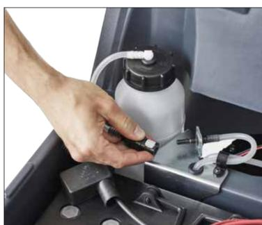
3. (si la machine est dotée du système de mélange du détergent) Remplissez le bidon avec un détergent adapté aux autolaveuses (fortement concentré et faiblement moussant).
