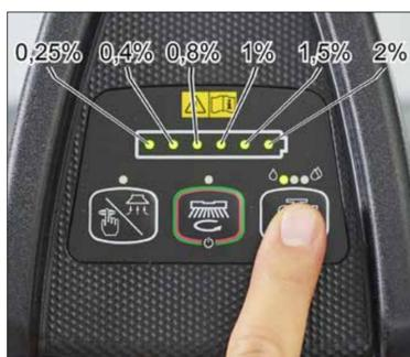
4. (si la machine est dotée d'un système de mélange du détergent) Activez la machine uniquement lorsque la LED de la batterie est allumée. Modifiez le pourcentage de détergent dans la solution de nettoyage en appuyant sur la touche de solution pendant 2 sec ; commutez ensuite la LED batterie sur le réglage souhaité en appuyant sur la touche de solution.
