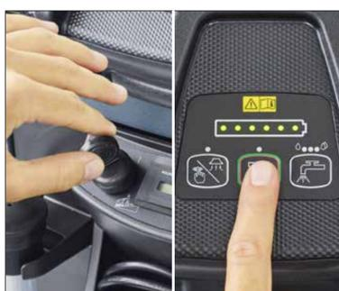
7. Si la machine est dotée d'une clé, tournez-la d'abord sur la position « I » et appuyez ensuite sur le bouton principal pour mettre la machine en marche. L'indicateur de batterie s'allume.
